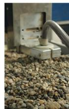
3) Die CNC Maschine befolgt den Code und druckt mithilfe einer Spezialvorrichtung das Objekt innerhalb des Substrats.
