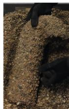
5) Das ausgehärtete Werkstück wird gesäubert und ggf. ausgeleert.
